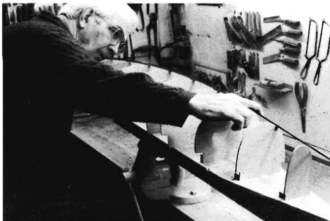
Bild 2: Die Spanten werden auf dem Baubrett ausgestrakt
