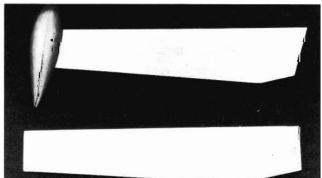
Polierte Kielflosse und fertiger Kiel aus 0,5-mm-V2A-Blech ▼
